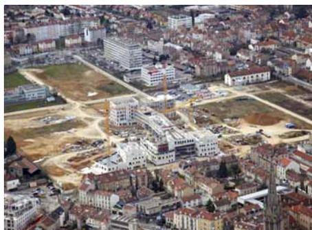
L'été 2011 marque un tournant majeur dans l'avancement du chantier d'ARTEM avec l'achèvement du gros œuvre. L'École Nationale Supérieure des Mines de Nancy voit « monter » ses cloisons intérieures (3<sup>ème</sup> niveau atteint en moyenne) et « avancer » la réalisation des ses façades, de la toiture végétalisée (au-dessus de la partie centrale de l'école), de la verrière (au-dessus de l'escalier dans le hall central).
